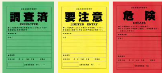
応急危険度判定の判定標識
